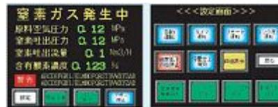
運転操作と運転状態はカラータッチパネルディスプレイで操作管理ができ、マイコンによる自己診断機能により、異常が起こると異常箇所をディスプレイに表示し、適切な対応が可能です。
